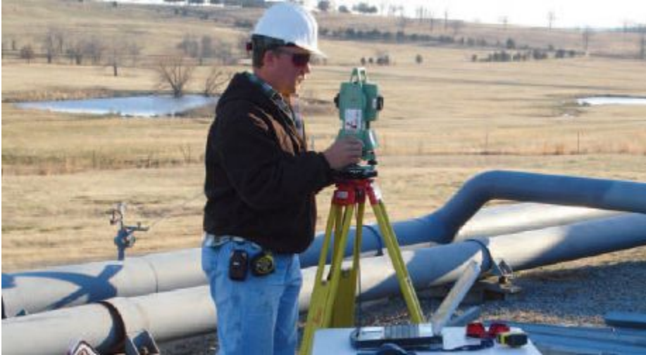
1 Инженер использует Leica Total station с CADWorx fieldPipe для создания исключительно точных моделей промышленных объектов прямо на месте работ
